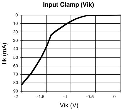
**GAL 16V8C-5/-7: TYPICAL AC AND DC CHARACTERISTIC DIAGRAMS**
